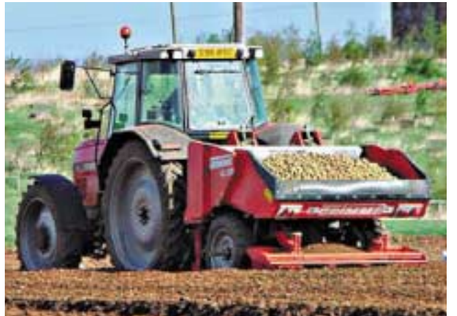
Yarı otomatik patates dikim makinelerinde, toprakta çizinin açılması ve kapatılması işlemlerini makine yapar; ancak yumrular çiziye bir işçi tarafından bırakılır. Otomatik makinelerdeyse işlemlerin bütünü makine yapar.
