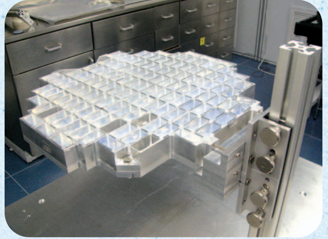
Stardust, yıldız tozunu aerojel gözelerinden oluşan, tenis raketi benzeri bir toplayıcıyla yakaladı.
