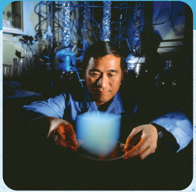
Yıldız tozunu yakalamada kullanılan "aerojel" adlı madde, çok küçük parçacıkları içinde hapsedebiliyor.
