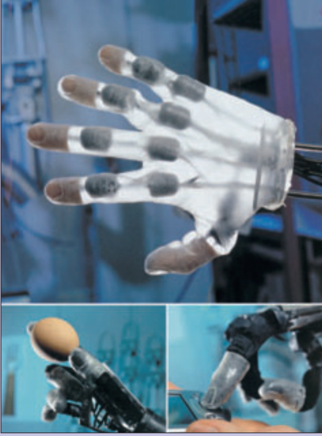
Fotoğraflarda, Almanya'daki Karlsruhe Araştırma Merkezi'nde geliştirilen "Fluid-Hand" adlı yapay el görülüyor. Araştırmacılar, yapay elin esnekliğini ve duyarlılığını insan eline benzetmeye çalışıyorlar. Yapay elin yumurta gibi kırılgan bir nesneyi kırmadan tutabilmesi ve cep telefonunun tuşlarını hissedebilmesi gerekiyor.
