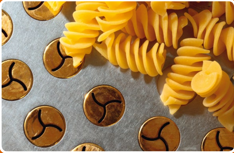
Bu fotoğrafta burgu makarnaları ve bu makarnaların şekillendirildiği delikleri görüyorsunuz.
