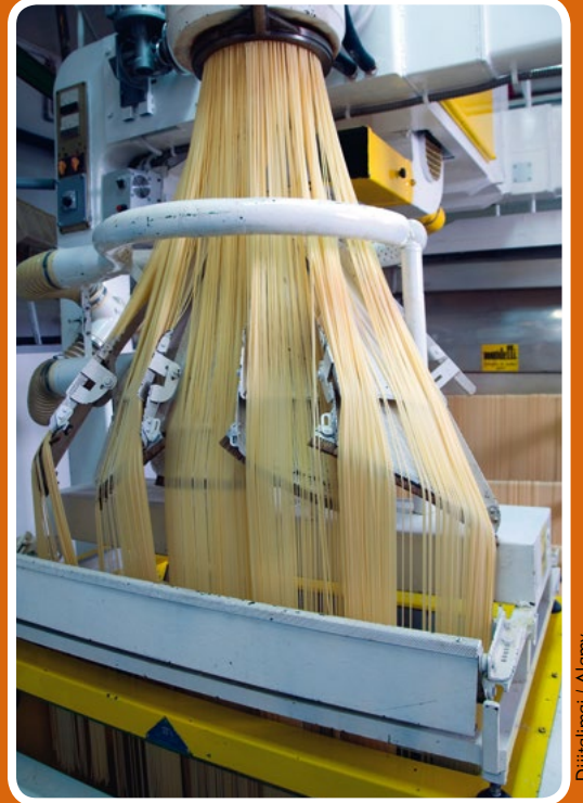
Bu fotoğrafta hamur şekillendirme makinesinden çıkan makarnaları görüyorsunuz.
