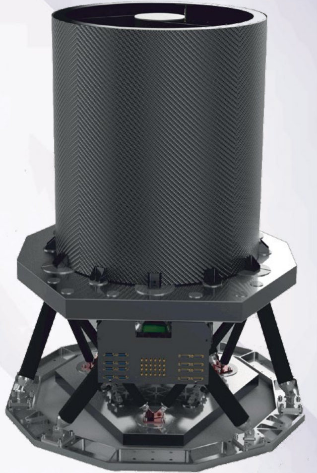
Yerli uydu İMECE’de kullanılan yüksek çözünürlüklü kamera
