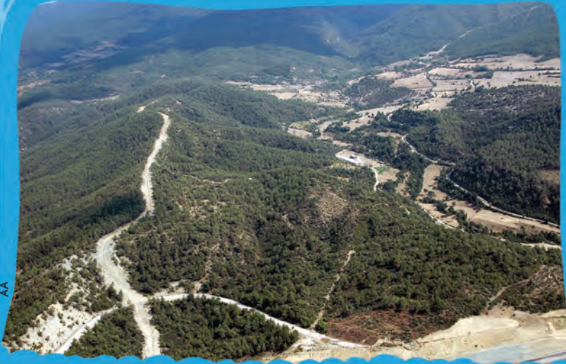
Yangın emniyet yol ve şeritleri hem yangınların yayılmasına bir engel oluşturur, hem de yangın yerine ulaşım amacıyla kullanılırlar.
