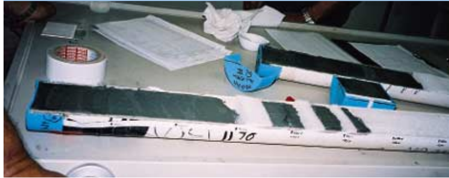
Calypso'nun deniz dibinden çıkardığı örnekleri taşıyan borular belirli aralıklarla kesiliyor. Daha sonra bu örneklerin kesitleri inceleniyor.
