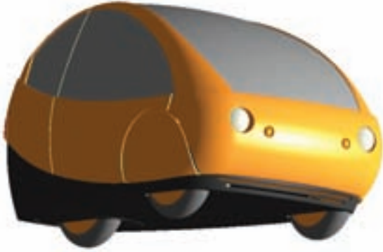
Bu otomobilin gövdesi ve camları üçboyutlu yazıcılar tarafından üretilmiş.
