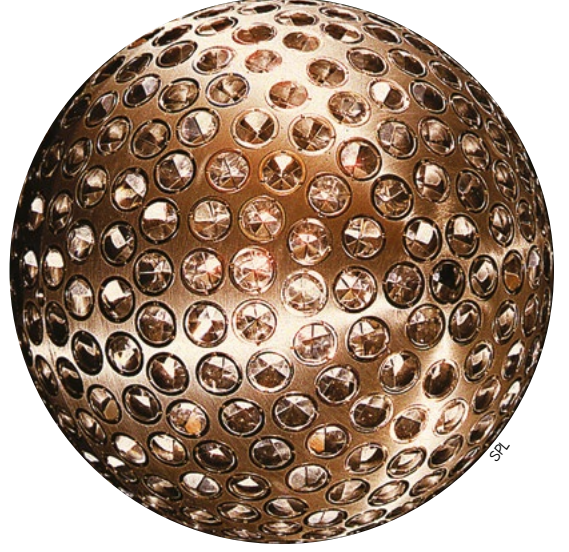
LAGEOS-1 çapı 60 santimetre olan alüminyum kaplama pirinç bir küre. Üzerinde ışığı yansıtan 426 parça var.
