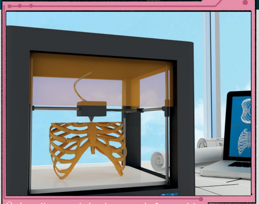
Üç boyutlu yazıcıda basılan göğüs kafesi modeli
