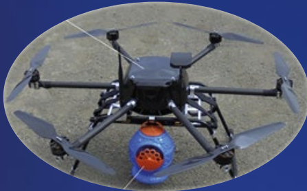
Baloncuk aygıtı monte edilmiş insansız hava aracı
