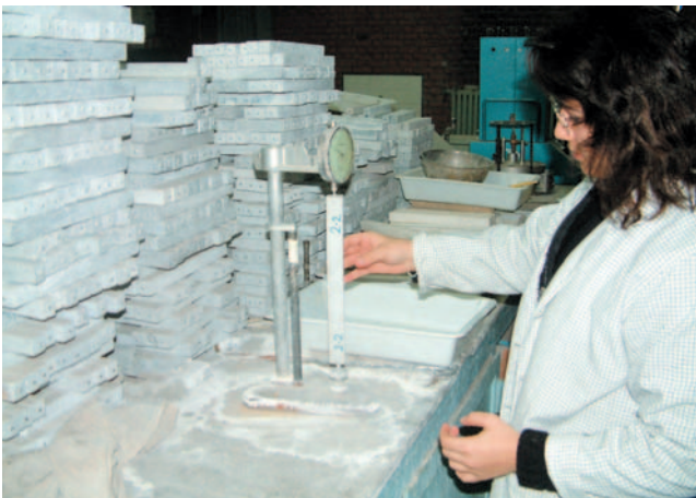
Hazırlanan beton kütleleri dayanıklılık testleri için baskı makinelerine koyuluyor (üstte). Çimento harçlarının genleşme durumları ölçülüyor.
