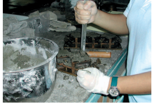
Inceleme amaçlı hazırlanan harçlar, büyük ya da küçük kalıplara dökülüyor.
