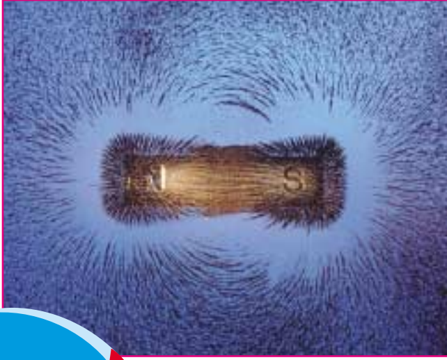
Üzerine demir tozu serpilmiş bir kâğıdın altına mıknatısı tuttuğunuzda bu görüntü oluşur.
