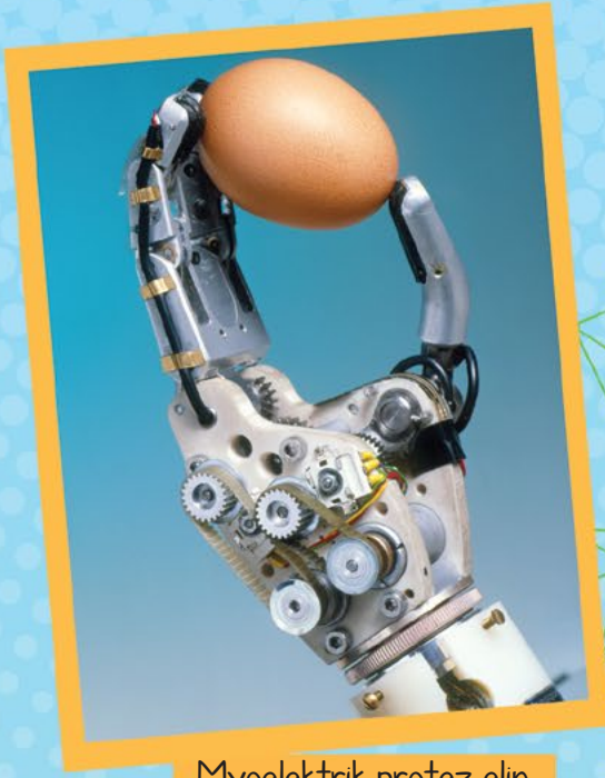
Myoelektrik protez elin mekanik düzeneği
